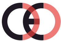
Virheellinen CE-merkki (liian lähellä)
